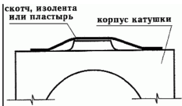
Рис. 14. Потеря колпачка редуктора
