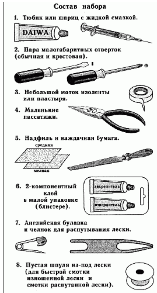
Рис. 2. Набор инструментов и принадлежностей для оказания первой помощи катушке
