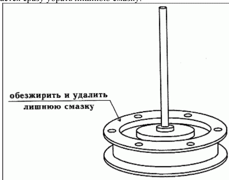
Рис. 85. Удаление лишней смазки с поверхности зеркала катушки
