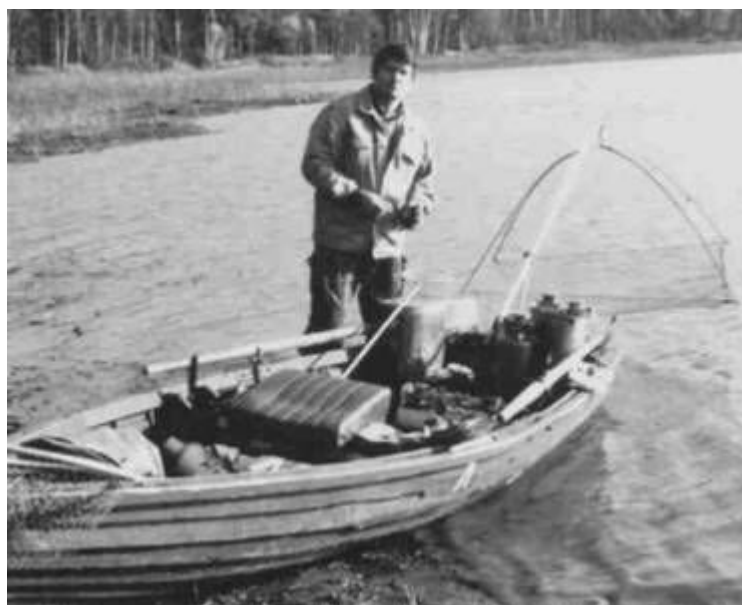
Фото 16. Один из наиболее универсальных вариантов подъемника, устанавливаемого на каркасную лодку или на надувную лодку с транцем
