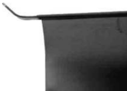
Фото 24. Оптимальный загиб пластины – фиксатора в месте контакта с плоскостью катушки
